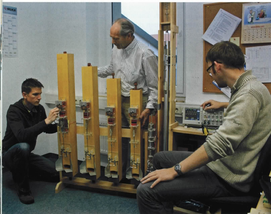
v.l.n.r.: Jan Färber, Orgelbaumeister Dieter Voigt (Ogelbau Voigt), Stephan Weller am Versuchsstand mit vier Prototypen der umstimbaren Orgelpfeifen
