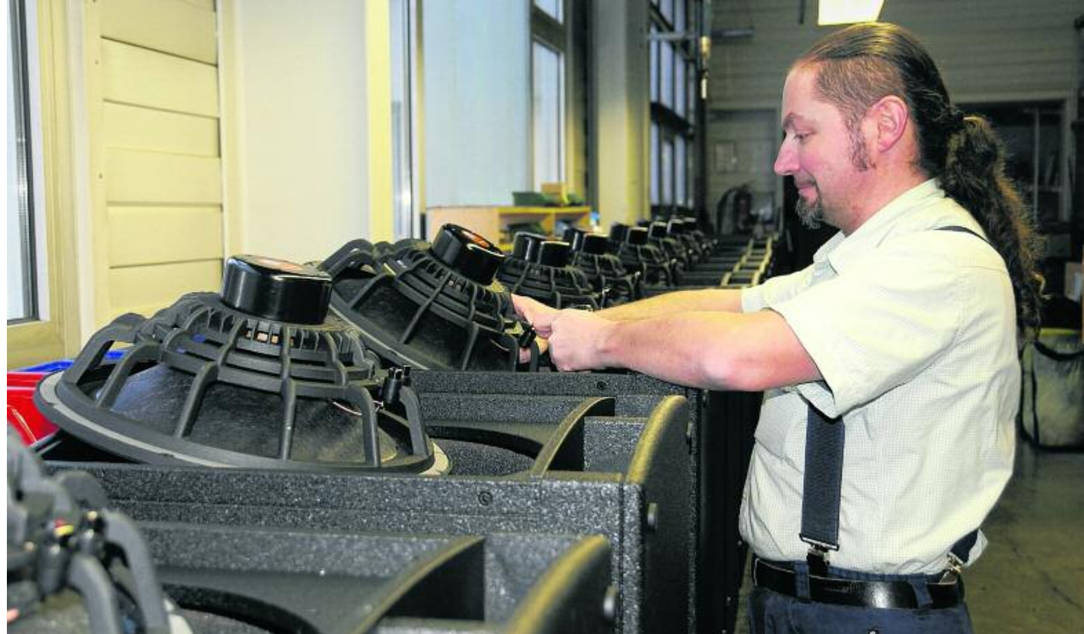
Mario Dähn bei der Klingenthaler Musikelektronik GmbH in der Endmontage der Lautsprecherfertigung.
