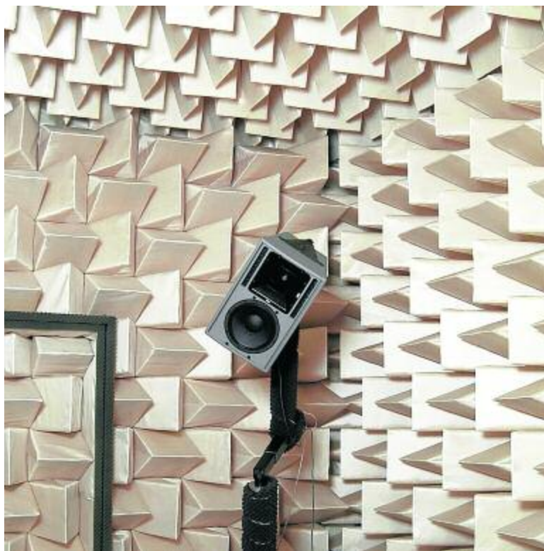
Herzstück des Unternehmens: Der Messraum, in dem alle Lautsprecher und Neuentwicklungen getestet werden.
