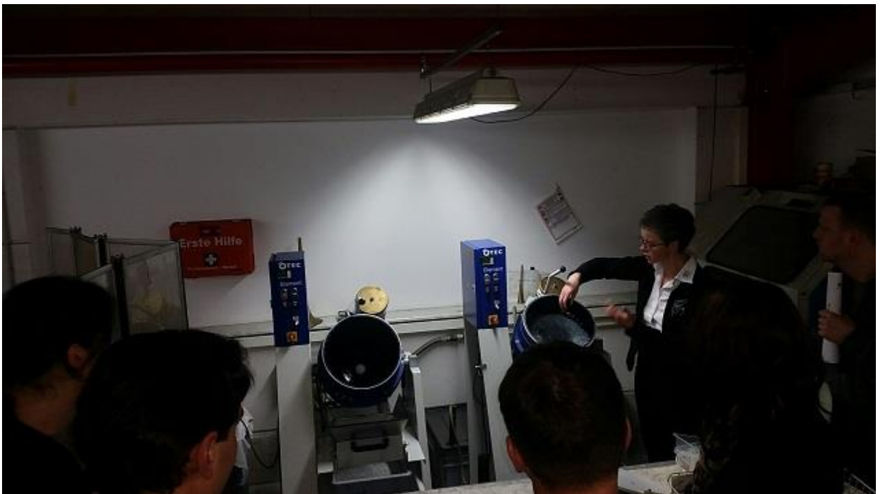
Entgraten und Polieren mittels einer Granulat Zentrifuge
